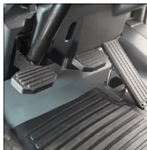
Disposição dos pedais com um automóvel e superfícies antiderrapantes.
