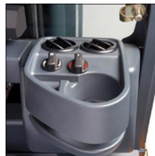
Aquecedor e saídas de ar para para-brisa frontal
