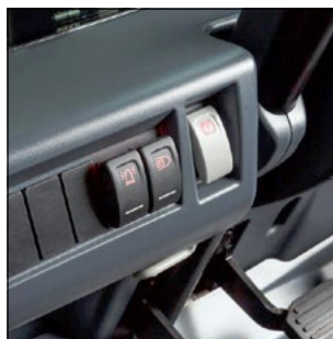
Freio de estacionamento acionável eletricamente, operação por botão.
